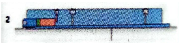
Figura 2.2 – O óleo é, então, bombeado para a câmara hidráulica, até escapar no furo aberto de 1/4" (1/2" para acoplamentos maiores) sem bolha de ar e o furo é fechado com um tampão.
