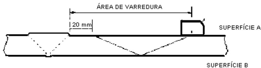
**Figura 7 – Área de Varredura – Juntas de Topo.**
